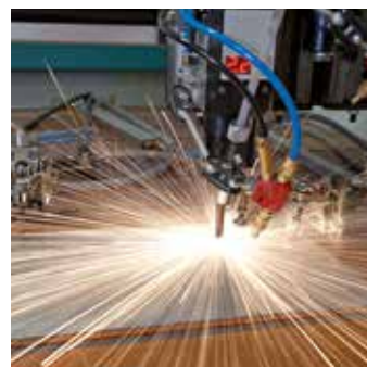
CNC gesteuertes Bolzenschweißen
